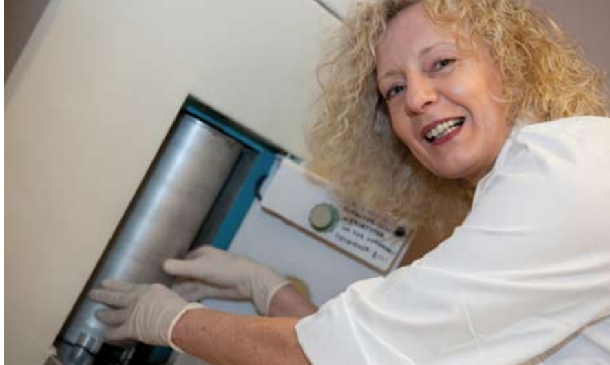
Strahlenquelle im Bestrahlungsgerät: Cäsium 137
